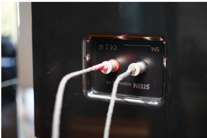
Highline L Signature的背板需要有特別的連線接法，這樣才能讓三個箱體正確發聲。
