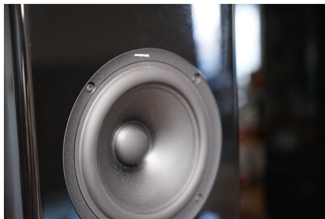
Highline L Signature的軟凸盆高音前面加了一個號角，中低音單體與低音單體都採用相同的150mm單體。
